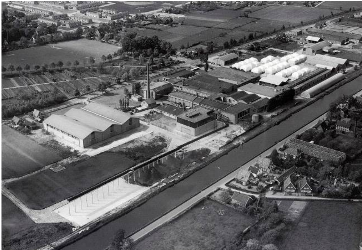
Vogelvluchtfoto vanuit het zuid-oosten uit 1961. Rechtsboven is op het noordelijke terrein de opslag van bolkaf zichtbaar onder plastic zeilen (witte iglo's). De grote drieslag (opslagloodsen voor bolkaf, gebouw 47) links op de voorgrond en hal 3 (extractiegebouw nr. 43) midden op de foto zijn dan nog maar een jaar oud, duidelijk te zien aan de lichte geveltint. Langs het kanaal op de voorgrond is de lange aan- en afvoerband op palen zichtbaar voor het bolkaf. Onder deze band werden langs het kanaal de hopen afval van het verwerkte bolkaf gedumpt, die weer op schepen werden geladen als meststoffen. (Archief CODA)
