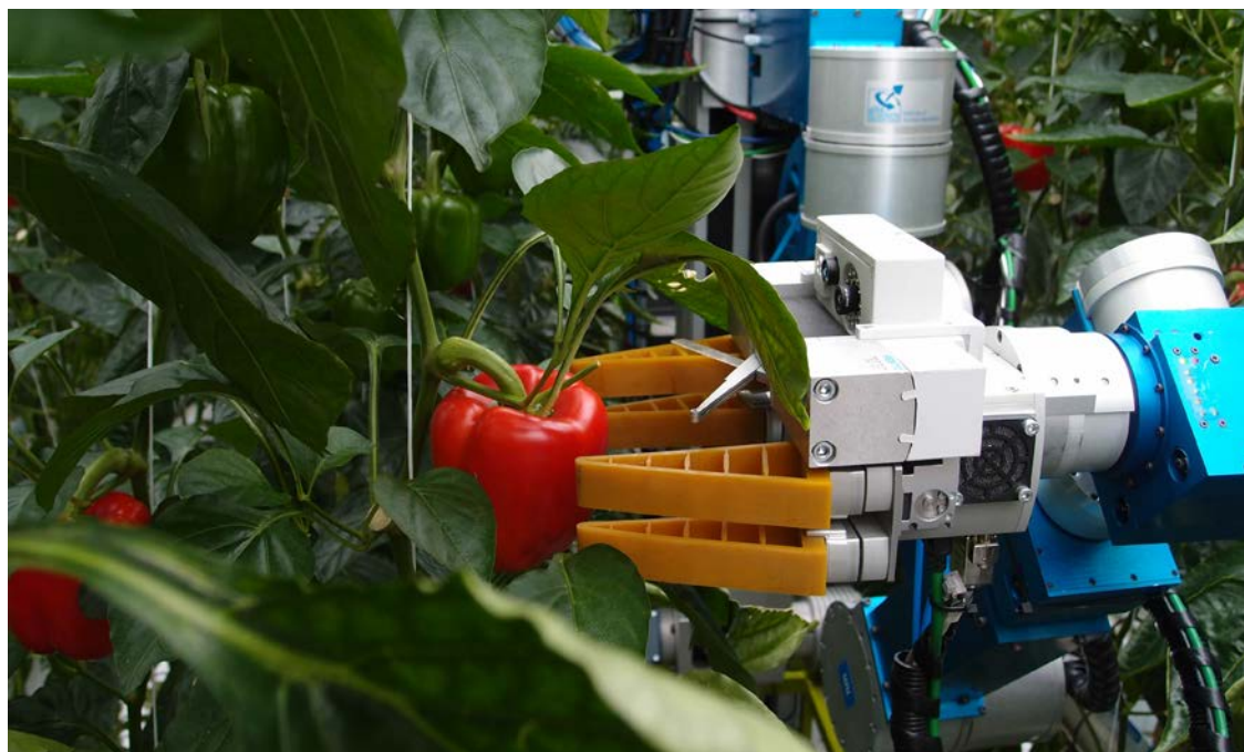
Figuur 6. Prototype van plukrobot voor paprika's kan op termijn het handmatig plukken gaan vervangen
